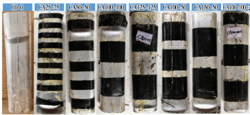
图5 最终破坏形态 Fig. 5 Final destructive form
