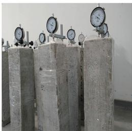
图 5 自由膨胀率试验
