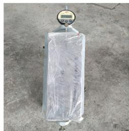
图 6 限制膨胀率试验
