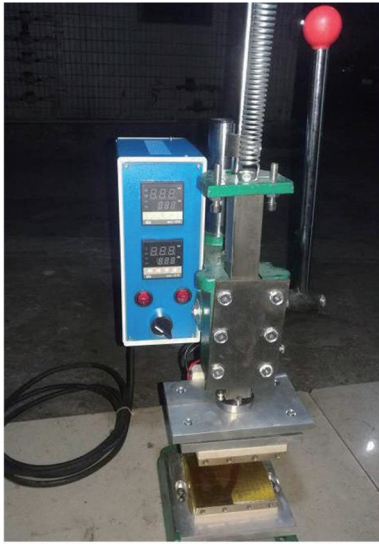
图2 IDM 实验室热压机 Fig. 2 IDM Test Room Hot Press
