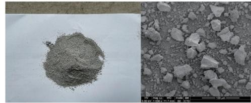
图 1 亲水性橡胶基本形貌图
