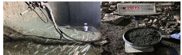
图 3 现场收集回弹量试验图
