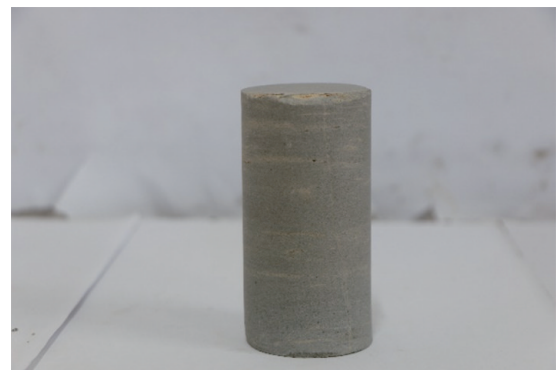
图 1 圆柱体岩样试件 Fig. 1 Cylinder rock sample diagram
