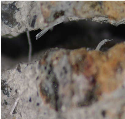
(b) 纤维拔出/断裂
