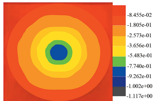
(a) 试样 A 的锈蚀损伤程度
