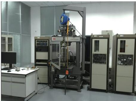
图 2 MTS-150 型力学试验设备
