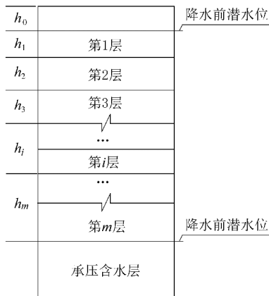
图 3 潜水降水引发沉降示意图
